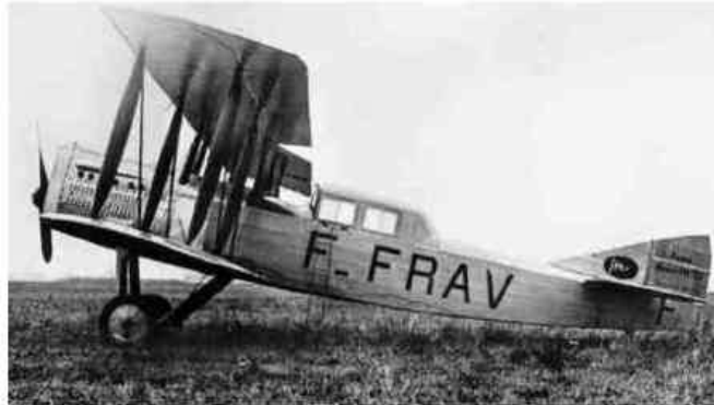
Jedna z mála fotografií Potezu typ VII zachycuje právě letoun výrobního čísla 133, označení F- FRAV, který 30.10.1922 havaroval v Supích skalách. Jednomotorový dvouplášník s cestovní rychlostí 170 km/h měl kromě místa pro pilota i kabinu pro dva cestující, létal v jasně žlutém nátěru, kryt motoru a kabina byly v barvě kovu (zdroj: internet).
